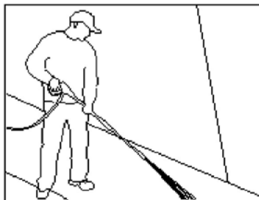
Рис. 6. Оптимальний кут розпилення води щодо поверхні.
